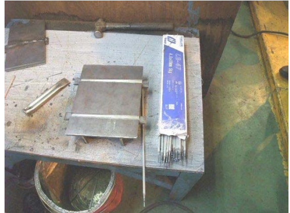
写真2 試験体と溶接棒 (被覆アーク溶接)
