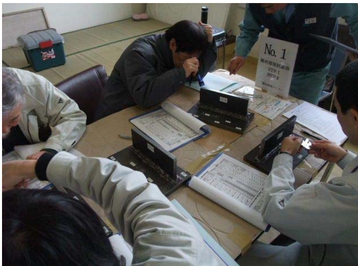
隅肉溶接試験体
