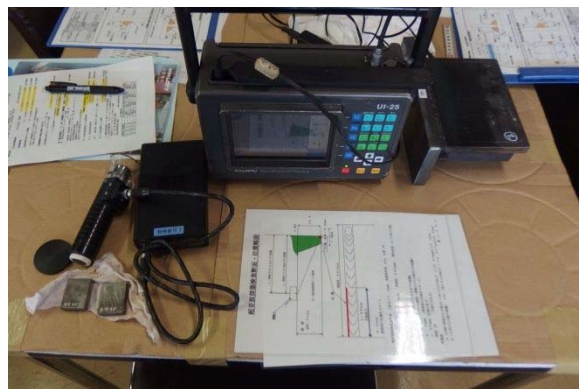
写真5 超音波探傷試験機器とサムスチールチェッカー
