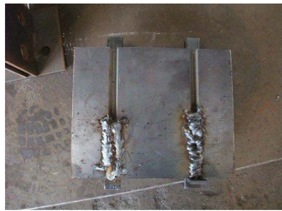
写真6 溶接部 (右:下向き、左:立て向き)
