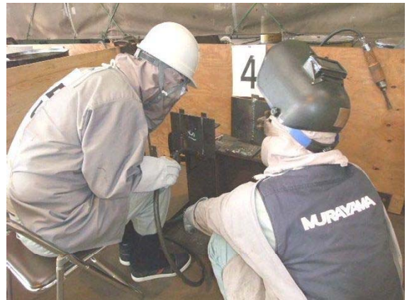
写真2 試験体と溶接棒 (被覆アーク溶接)
