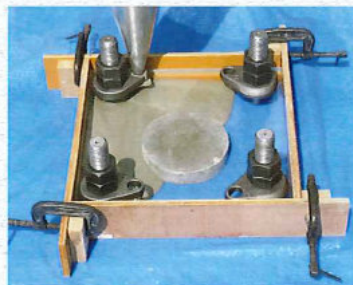
▲グラウト充填実験 (アクリル製ベースプレートによる充填確認)
