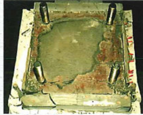
▲一般グラウト施工実験 (充填不良発生)
